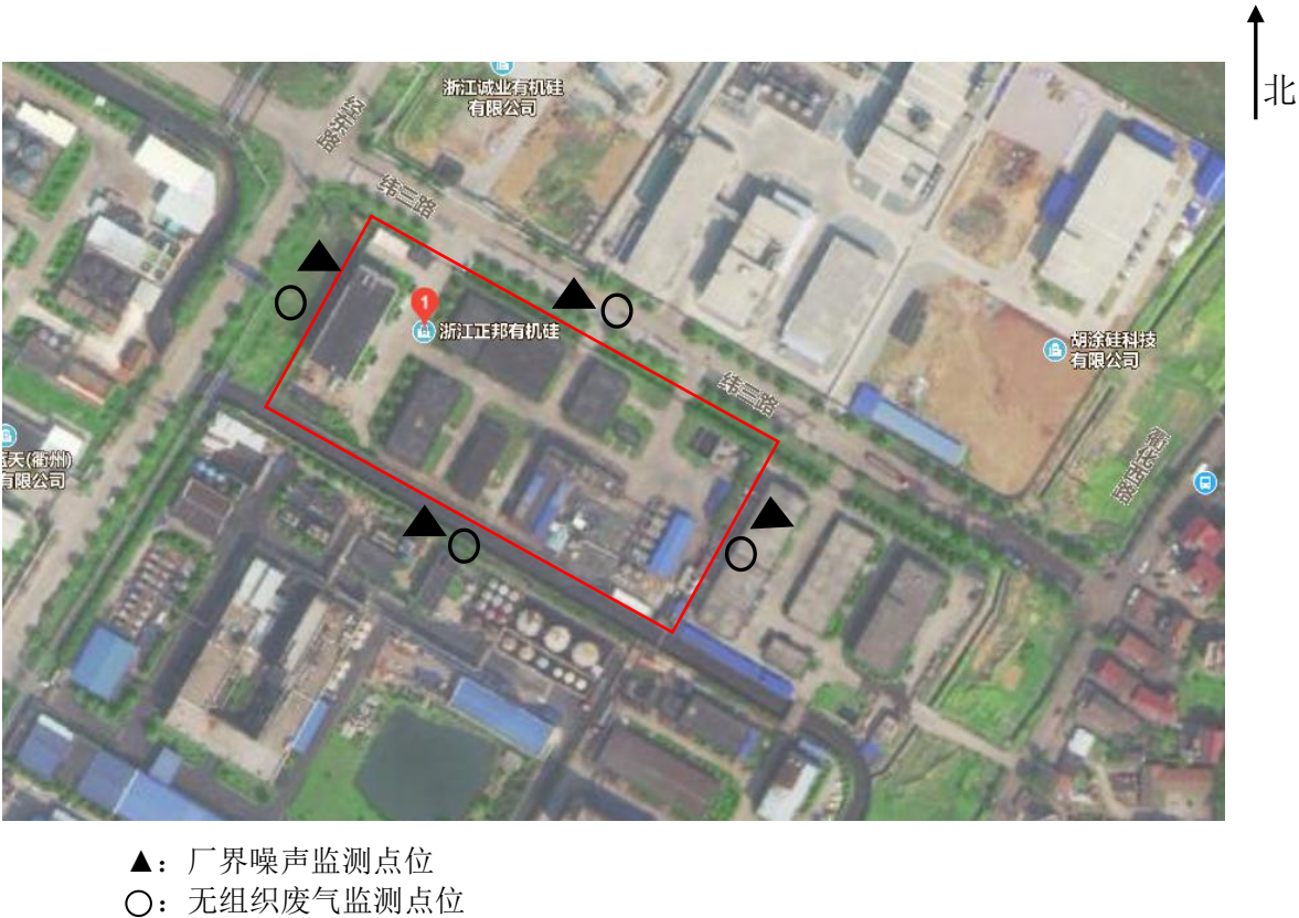
图 8-3 无组织排放废气、厂界噪声监测点位示意图
