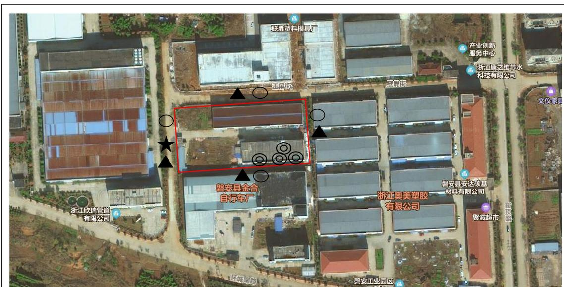
▲噪声检测点    ○ 无组织废气检测点    ⊙ 有组织废气监测点    ★ 废水监测点位
